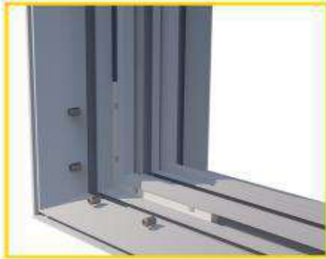
4 - Fixe os parafusos sem cabeça fornecidos para fixar os dois perfis usando a chave fornecida
